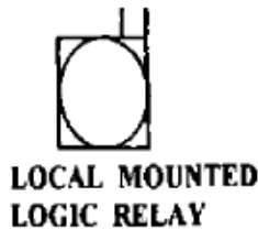
رله منطقی نصب شده در محل
