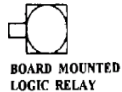
رله منطقی نصب شده در تابلو
